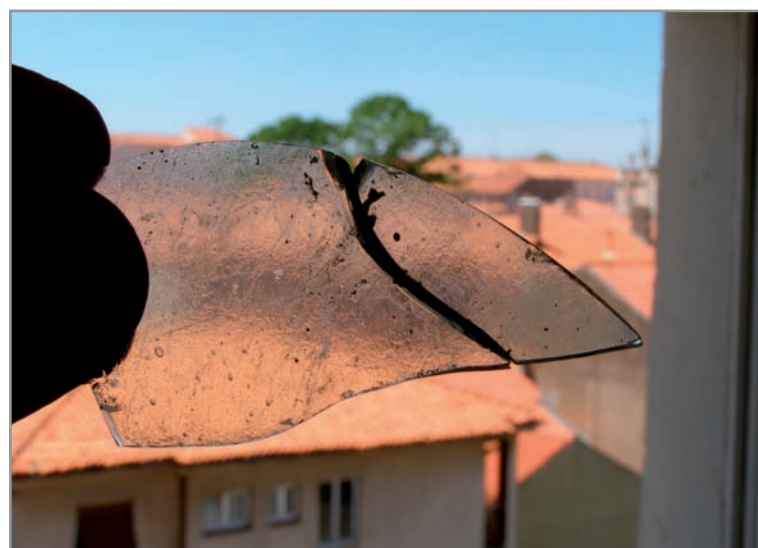
Sl. 6 Rezultat lijepljanja vezivom pripremljenim od vapna i jajeta
