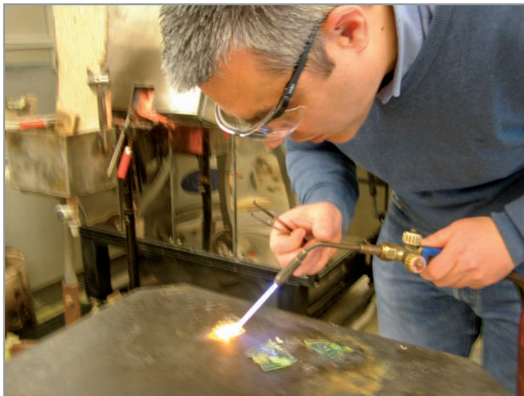
Sl. 3 Eksperiment Plinijevog lijepljenja stakla uz pomoć sumpora
